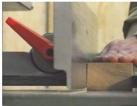
fig. 18: função da paralela
