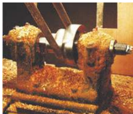
o cabeçote de arranque com o seu corpo de rosca no ponta motriz
