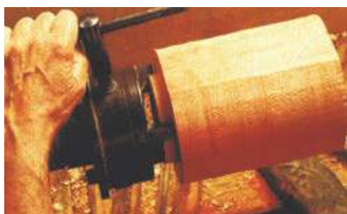
Com o porta - brocas universal fixa-se a peça de madeira no torno para iniciar o seu desbaste
