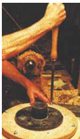
A peça de madeira é aparafusada no prato de arranque para posterior torneamento
