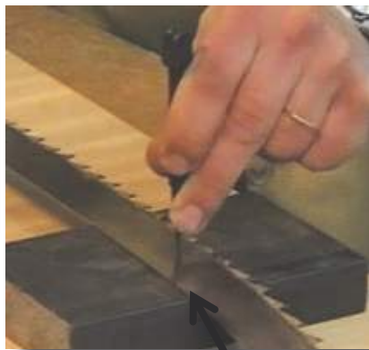
Furo com um punção no extremo da fissura
